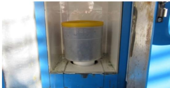
**Abbildung 20 Probengefäß im Gammadetektor**
