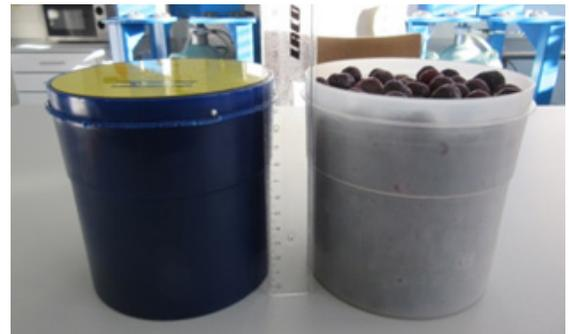
**Abbildung 19 Probenbehälter für Gamma-Spektrometrie**
