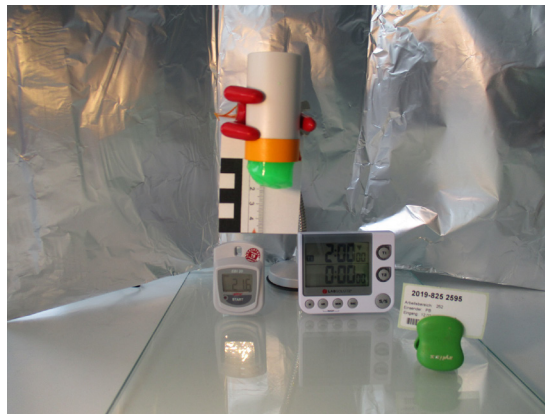
Abbildung 31 Testaufbau zur Bestimmung der Konsistenz
