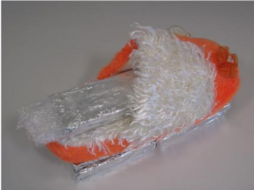
**Abb. 21:** Ein mit PE-Folie umwickelter Stempel mit einer Seitenoberfläche von 1 dm<sup>2</sup> wird in den zu untersuchenden Schuh gelegt.
